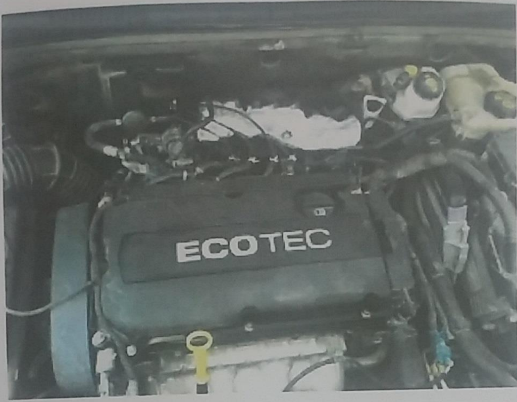
Resim 13 Benzinli araçta kullanılan alternatif yakıt sistemi
